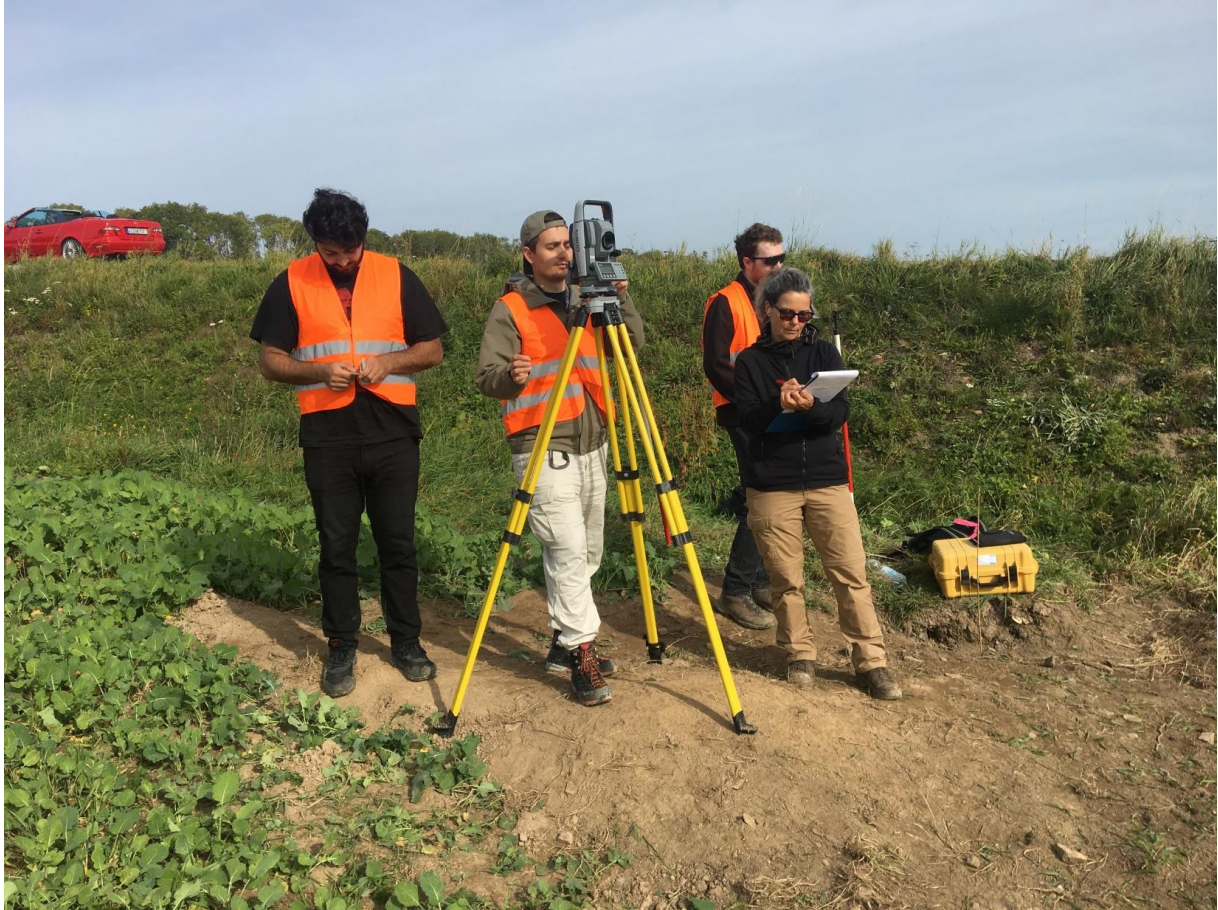
Abb. 3 Einmessung von Funden mit einem differentiellen GPS
